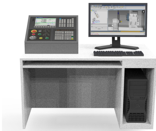
图 4 虚拟调试硬件平台原理示意图
